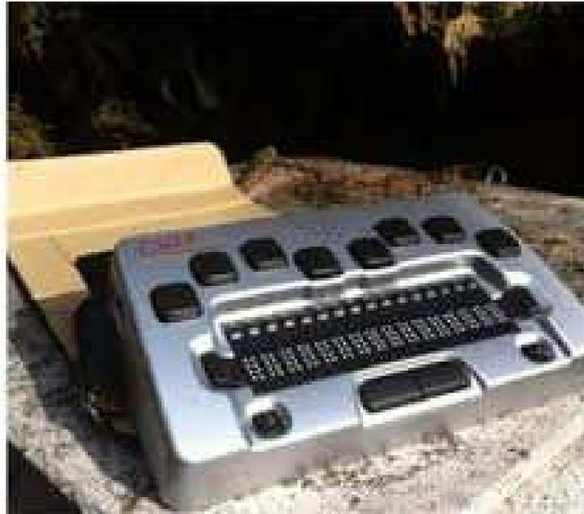
**Luce** è un display braille di 16 caratteri, piccolo e compatto con tastiera stile Perkins incorporata che permette di prendere appunti velocemente, leggere e scrivere testi, ed effettuare semplici operazioni matematiche.
